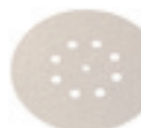
FOGLI ABRASIVI forato, Ø 150 mm, con fissaggio rapido a velcro Campo di applicazione: metallo, carrozzerie non verniciate, punti di brasatura, punti di saldatura, vetroresina. Qualità: panno per smerigliature di elevate prestazioni, legato in resina sintetica, corindone. Proprietà: alta stabilità, elevata capacità di asportazione.
